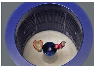
As marcações internas presentes no conformador de anel orientam o técnico sobre o posicionamento exato da restauração no ato da desinclusão.
