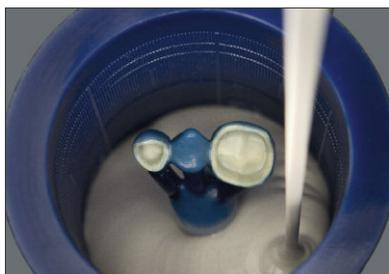
Vazar revestimento sem bolhas e de forma cuidadosa até alcançar a marcação no conformador de anel.
