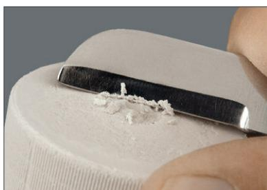
O nivelador determina a altura do anel de revestimento bem como o posicionamento correto no forno de injeção. Irregularidades na base de apoio devem ser removidas e aplainadas com faca de gesso, pois senão, o anel não ficará numa posição estável no forno de injeção podendo trazer problemas na hora da injeção.
