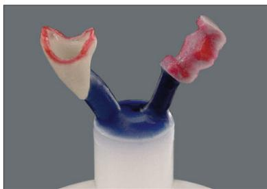
Pontos de conexão entre canal de alimentação, padrão de cera e base conformadora de anel têm que estar arredondados. Cantos agudos ou estrangulamentos precisam obrigatoriamente ser evitados. Os canais de alimentação em direção ao padrão de cera não devem ficar mais estreitos, e sim, apresentar um alargamento.
