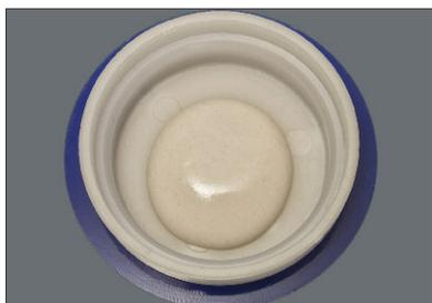
Afastar as paredes do conformador de anel com os polegares antes de posicionar o nivelador, para que o ar possa escapar melhor.
