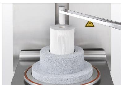
Colocação do êmbolo de injeção descartável com a marcação em preto para cima. A face levemente arredondada deve estar posicionada para baixo.
