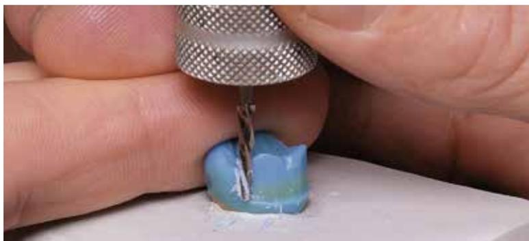
Cera de fresagem dura opaca especialmente desenvolvida para o processamento mecânico na técnica de fresagem. A cera de fresagem, devido ao intervalo de fusão baixo e estreito, é adequada para a modelagem rápida e eficiente de enceramento telescópico, de coroas e pontes e fresagem consecutiva.
