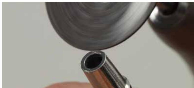
Discos de corte e desgaste flexível, estável, reforçados com fibra de vidro, especiais para corte e desgaste de protocolo de implantes como pilares, barras e estruturas de titânio e ligas de titânio.
