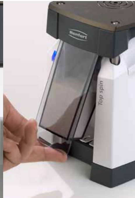
“O interruptor principal é acionado utilizando um sensor de toque inovador tornando-o mais econômico. O equipamento encontra-se então no modo de espera. O fuso de perfuração é ativado automaticamente quando a mesa é abaixada. Após 2 minutos sem uso, o interruptor principal desativa-se automaticamente.”
